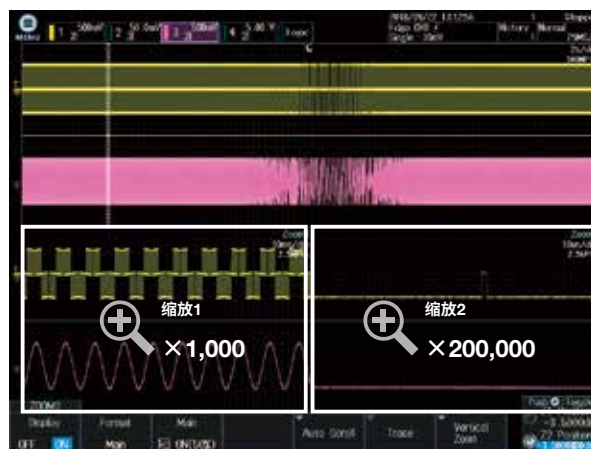
以20毫秒和100微秒跨度显示20秒测量波形的细节。
