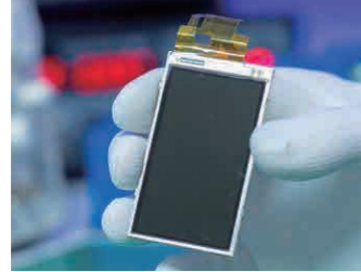
用于移动设备的OLED: 0.001 - 500 cd/m 2 Ø27 CA-VP427高感探头 保证精度的亮度测量范围 0.001 - 3,000 cd/m 2
