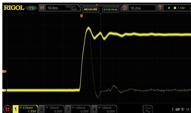
高刷新率模式下捕获偶发异常信号
