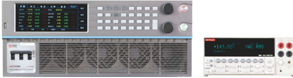
PRE15输出150V实测电压精度：0.016% F.S.
